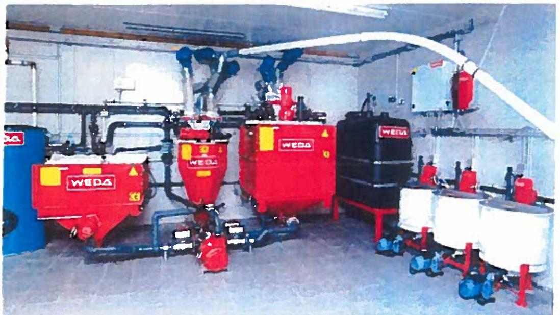
Die Einzelkomponenten der Weda-Flüssigfütterungsanlagen können einfach miteinander kombiniert werden.
